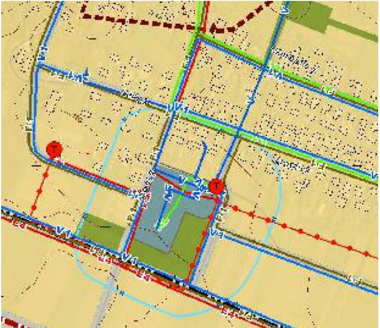
1 pav. Ištrauka iš Eišiškių miesto bendrojo plano ištrauka (Esama vandenvietė su mikrobinės apsaugos II juosta ir projektuojamais tinklais V1-vandentiekio; F1- nuotekų)
